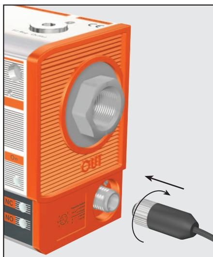
Un unico connettore standard M12x1 a 5 poli, con grado di protezione IP67, serve sia per la elettrovalvola di apertura che per il pressostato. Basta così un unico cavo migliorando l'affidabilità e riducendo il tempo di cablaggio.
