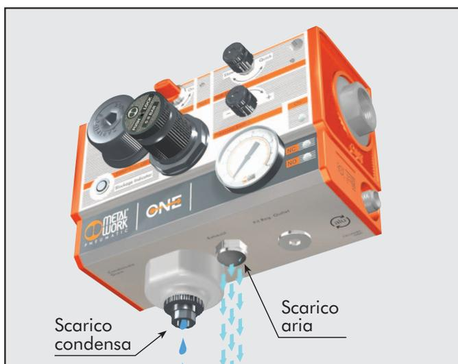
L'aria viene scaricata da un'unica uscita, posta sotto al gruppo e completa di silenziatore. Chi desiderasse convogliare lo scarico, per non immettere aria eventualmente inquinata nell'ambiente, può togliere il silenziatore e fissare un raccordo (si consiglia l'uso di un tubo con passaggio non inferiore a 6 mm). A fianco dello scarico dell'aria c'è lo scarico della condensa, che nella versione RA è convogliabile montando un raccordo da 1/8" sul filetto.
